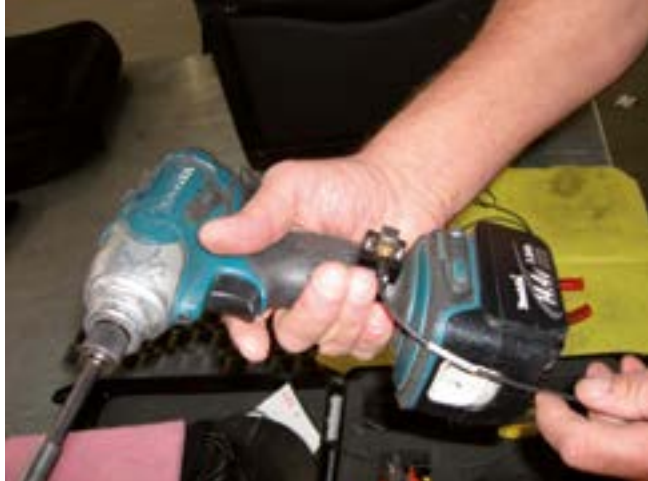
(links) Abb. 21: Elektro-Schrauber mit angekoppeltem Schwingungs-Aufnehmer während einer Messung
