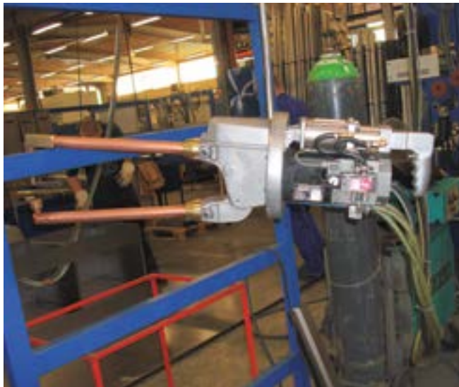
(links) Abb. 18: Einsatz einer Punktschweiß-Zange mit Balancer-Aufhängung
