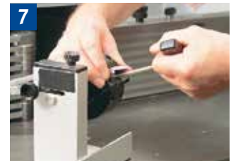
Lösen der Spannschrauben mit vorgegebenem Werkzeug (Imbusschlüssel)
