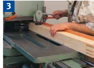
Handvorschub = Arbeiten mit dem Schiebeshlitten
