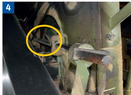
Formschlüssige Sicherung gegen Herabsinken des Sägerahmens.
