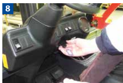
8 Gabelstapler erst verlassen, wenn der Antrieb stillgesetzt, die Feststellbremse angezogen, die Gabeln auf den Boden abgesenkt und der Schlüssel abgezogen ist.
