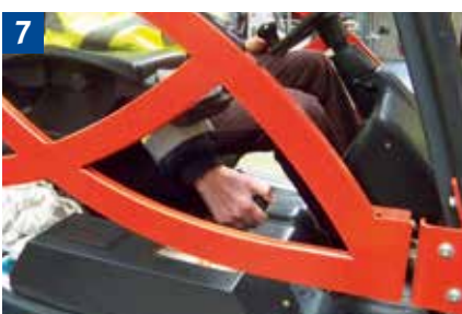
7 Vor Verlassen des Flurförderzeuges Feststellbremse anziehen und Gabeln absenken. Auf geneigten Flächen zusätzlich durch Unterlegkeile das Wegrollen verhindern.
