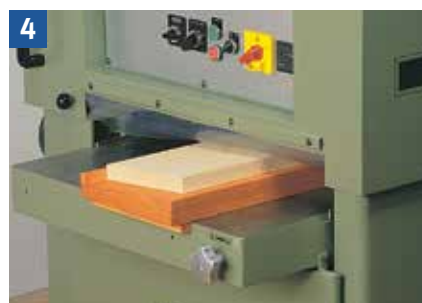
Hobeln mit Schablone. Bei nicht parallelen Flächen geeignete Schablonen verwenden.
