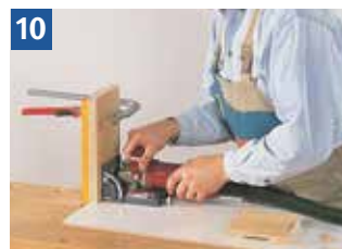
10 Einfräsen von Nuten mit Stützwinkel
