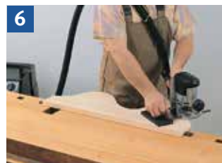
6 Bearbeiten von Werkstückkanten mit der Handoberfräsmaschine
