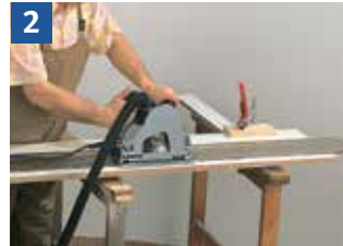
2 Sägen von Plattenmaterial mit Führungsschiene
