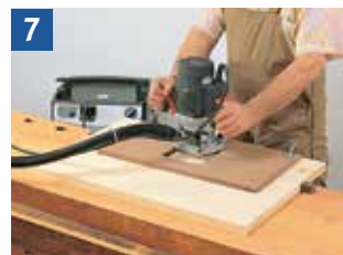
7 Einsatz der Handoberfräsmaschine mit Schablone
