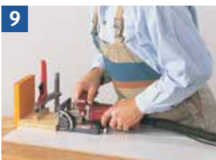
9 Einfräsen von Nuten, kleine Werkstücke festspannen.
