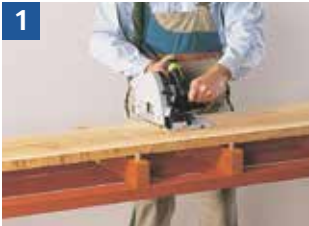
1 Sägen von Massivholz auf Unterlagen mit Anschlagknoppen
