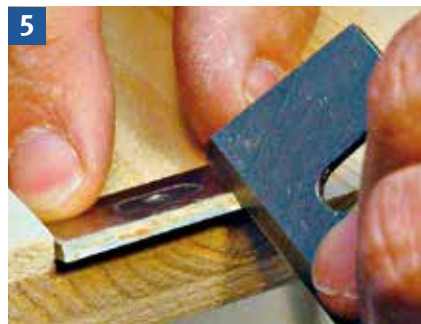
Achtung! Wendeplatten, Plattensitz und Spannkeil von Ablagerungen säubern, z. B. Harz- und Holzstaubablagerungen abschaben.
