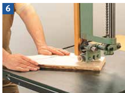
Handhaltung beim Herstellen geschweiften Werkstücke
