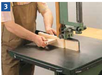
Auftrennen am Anschlag mit Zuführlade
