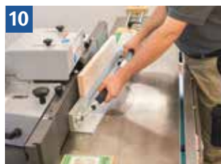
10 Einsetzfräsen kleiner Werkstücke mit Spannlatte und Rückschlagsicherung
