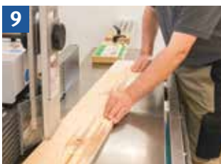
9 Einsetzfräsen großer Werkstücke mit Rückschlagsicherung
