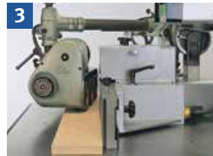
3 Fräsen von geraden Werkstücken am Anschlag mit Vorschubapparat
