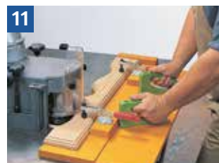
11 Fräsen von geschweiften Werkstücken mit Anlauftring und Bogenfräshaube
