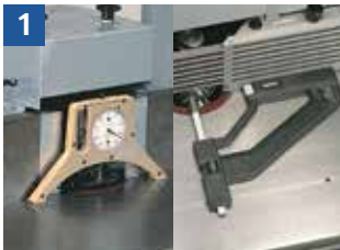
1 Einstellen von Fräshöhe und Frästiefe mit Messuhr
