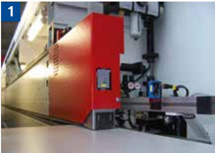
Werkstückaufgabe gesichert, z. B. durch eine elektrisch verriegelte Pendelklappe
