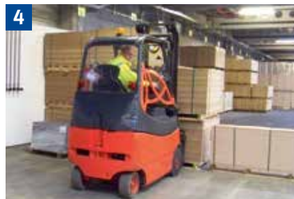
4 Niemals ohne Sicht fahren. Ausnahmsweise beim Transport hoher Lasten rückwärtsfahren oder sich einweisen lassen.
