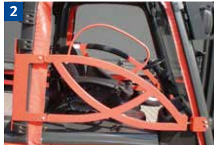
2 Fahrerinnen und Fahrer müssen bei jeder Fahrt Rückhalteeinrichtungen (z. B. Sitzgurt oder Bügeltür) benutzen.
