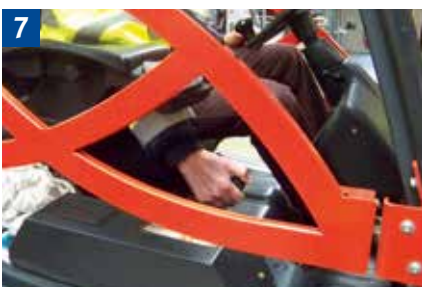
7 Vor Verlassen des Flurförderzeugs Feststellbremse anziehen und Gabeln absenken. Auf geneigten Flächen zusätzlich durch Unterlegkeile das Wegrollen verhindern.
