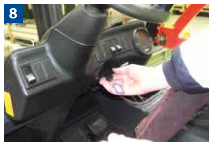
8 Gabelstapler erst verlassen, wenn der Antrieb stillgesetzt, die Feststellbremse angezogen, die Gabeln auf den Boden gesenkt und der Schlüssel gezogen ist.
