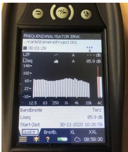
Abb. 22 Terz-Frequenz- analyse mit der Software des Messgeräts
