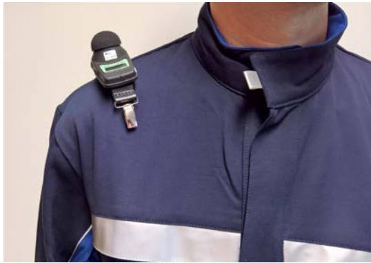
Abb. 15 und 16 Lärmdosimeter
