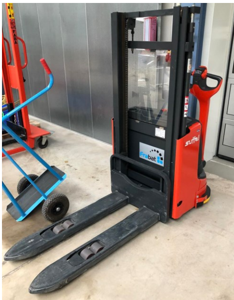
Gerät: Mitgängerfahrzeug Linde L10, Nennlast 1000 kg
