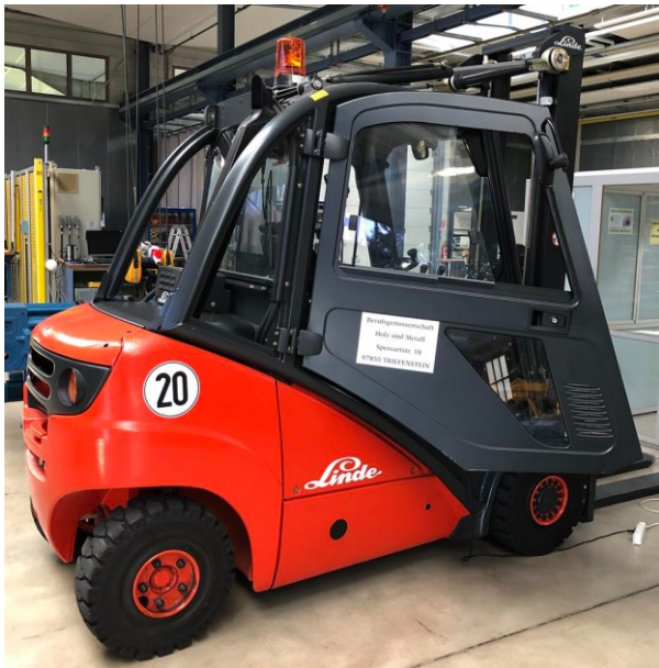
Gerät: Frontgabelstapler, Nennlast 2.500 kg
