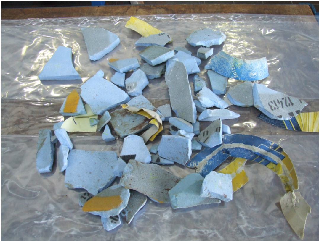
Bruch einer keramisch gebundenen Schleifscheibe
