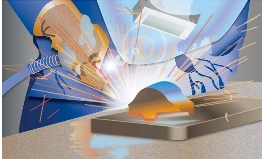
Eine Maßnahme, um Schweißrauche zu reduzieren: eine brennerintegrierte Absaugung
