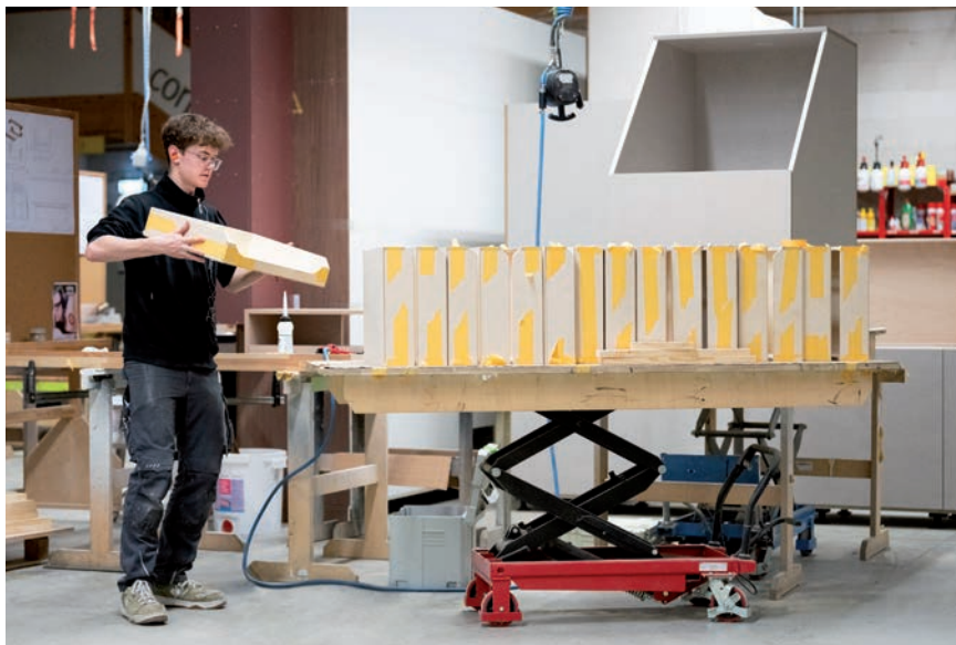
Ergonomisch: Mit den fahrbaren Hubtischen gelangen Material und Handwerkzeuge auf die richtige Höhe und an den richtigen Ort.
