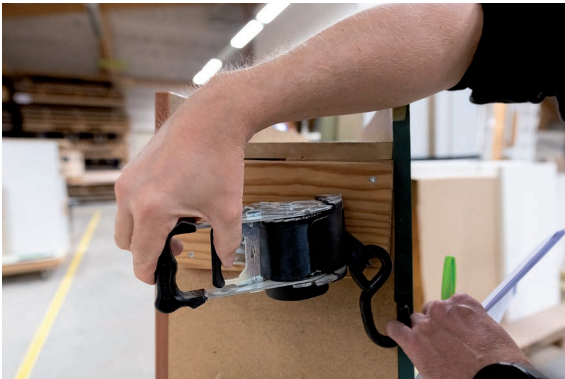
Einhandig bedienbare Rollgurte sind eines der Mittel, die die Arbeit bei corpuslinea sicherer machen.
