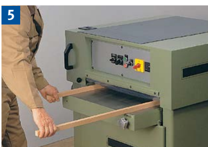
Hobeln schmaler Werkstücke. Bei starren Einzugs- und Druckwalzen und Druckbalken maximal zwei Werkstücke gleichzeitig bearbeiten.
