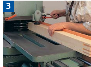
Handvorschub = Arbeiten mit dem Schiebeshlitten
