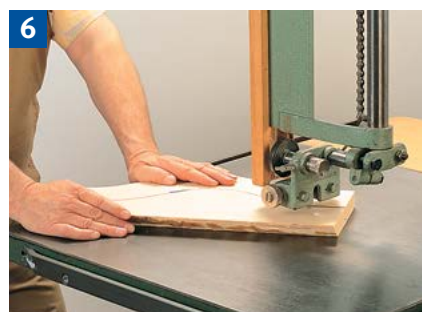
Handhaltung beim Herstellen geschweiften Werkstücke.
