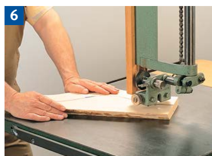
Handhaltung beim Herstellen geschweiften Werkstücke.
