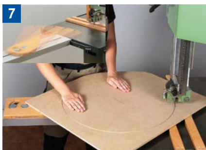
Vorrichtung und Handhaltung beim Herstellen kreisförmiger Werkstücke.
