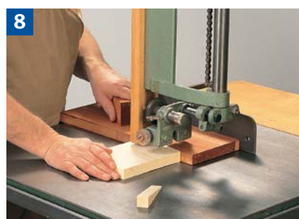
Sägen von Keilen mit Keilschneidlade.
