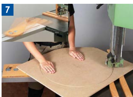
Vorrichtung und Handhaltung beim Herstellen kreisförmiger Werkstücke.
