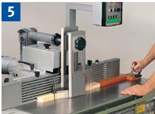
5 Fräsen von kleinen Werkstücken am Anschlag mit Druck- und Schutzvorrichtung und Schiebeholz.
