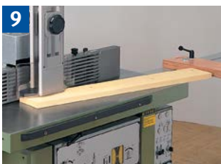
9 Einsetzfräsen großer Werkstücke mit Rückschlagsicherung.
