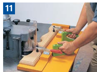
11 Fräsen von geschweiften Werkstücken mit Anlaufing und Bogenfräshaube.
