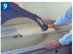
9 Schutzeinrichtung und Handhaltung beim Fälen.
