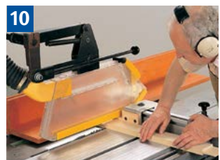
10 Schutzeinrichtung und Handhaltung beim Absetzen von Zapfen.
