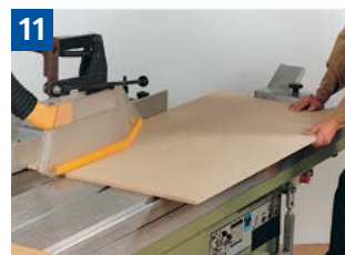
11 Schutzeinrichtungen und Handhaltung beim Einsetsägen. Sägeblatt wird von unten nach oben durch das Werkstück angehoben.
