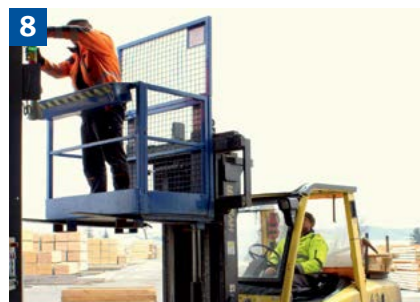
Instandhaltungsarbeiten mit Gabelstapler und Arbeitsbühne
