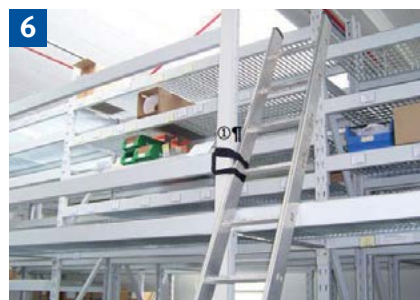
1 Sicherungsmöglichkeit durch Anbinden oder eine zweite Person.
