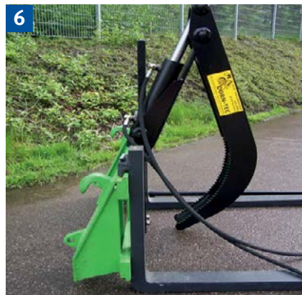
Gabelstapler mit Zangengreifer zum Transport von Rundholz.
