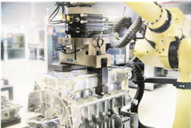
Bild 8: Formschlüssiger pneumatischer Greifer am Roboter
