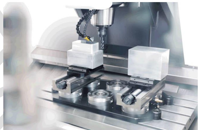
Bild 4: Pneumatisches Nullpunktspannsystem mit Werkstücken in mechanischen Schraubstöcken
