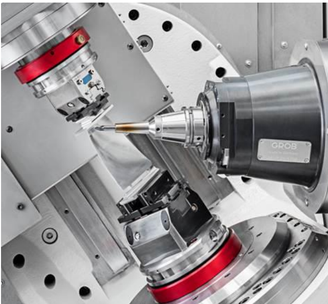
Bild 3: Zwei pneumatische Spannstöcke in CNC-Universal-Bearbeitungszentrum
