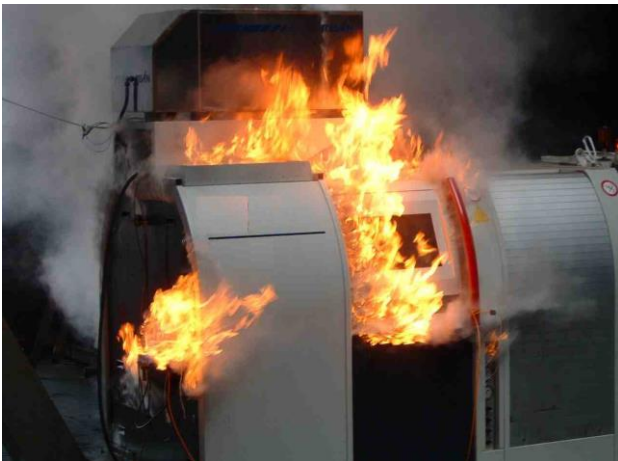
Bild 1: Flammenaustritt im Türbereich bei einer Zündung des KSS/Öl-Luft Gemisches im Arbeitsraum
