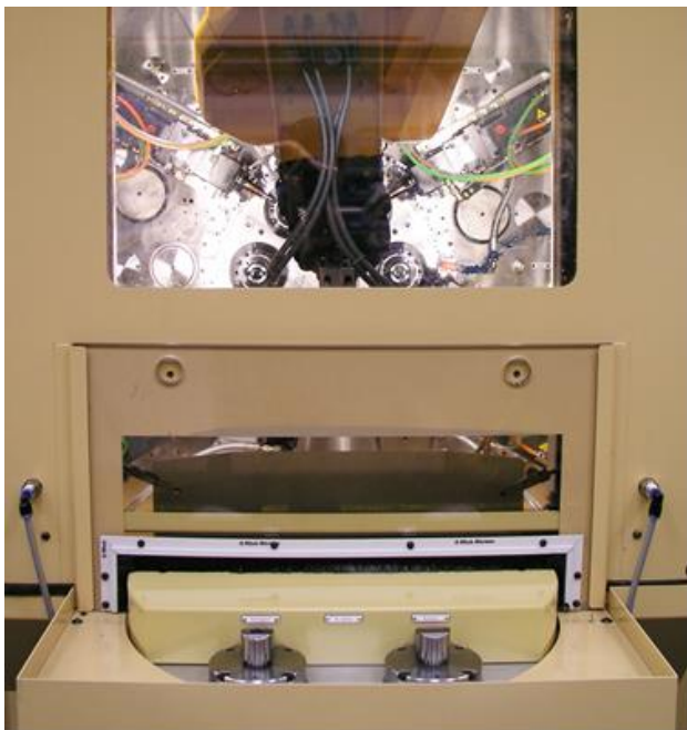
Bild 7: Teile Zuführ- und Abführstation für Roh- und Fertigteile an einem Mehrspindeldrehautomat
