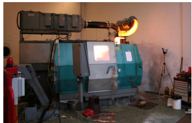
Bild 2: Flammendurchschlag in die Absaugung
