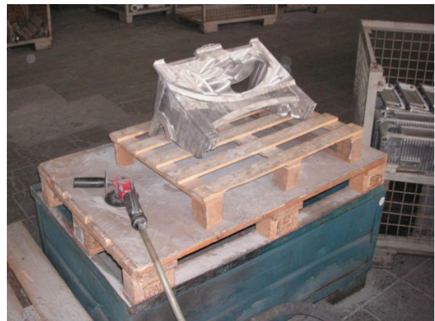
Bild 2: Ungeeigneter „improvisierter“ Schleifarbeitsplatz
