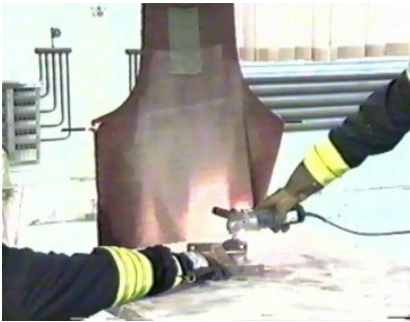
Bild 3: Funkenflug auf eine mit Magnesiumstaub behaftete Segeltuchschürze
