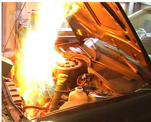
Bild 1: Explosion (Verpuffung) im Motorraum
