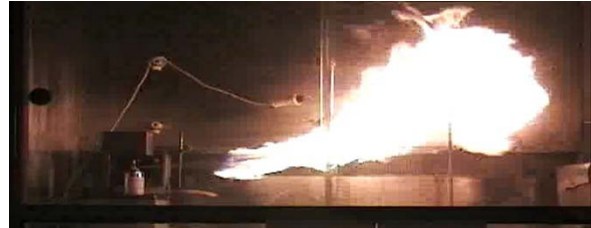
Bild 5: Flammenrücklauf zur Druckdose
