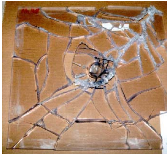
Abb. 3: Durch Kühlschmierstoff versprödete und beim Aufprall von Teilen gebrochene Polycarbonatscheibe
