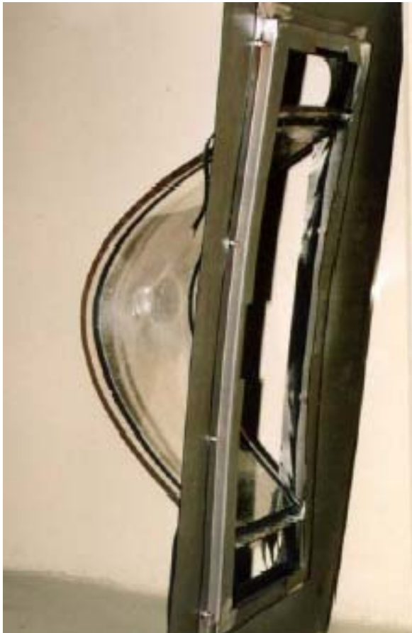
Abb. 4: Durch den Aufprall von Teilen herausgedrückte Sichtscheibe
