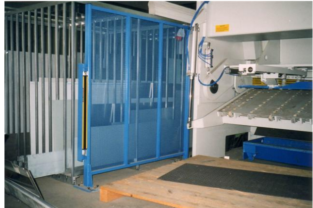
Bild 3: Lichtschranke an der Rückseite einer Tafelschere
