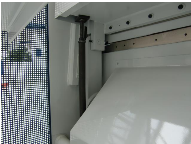
Bild 4: Hochhalteeinrichtung für Einrückung der Messerbewegung
