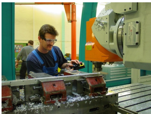
Abb. 1: Prozessbeobachtung bei Einzelfertigung auf einem Bearbeitungszentrum. Im 1/100 mm – Bereich sind Störkanten zu glätten, wobei eine Kollisionsgefahr an Werkstückkonturen besteht.
