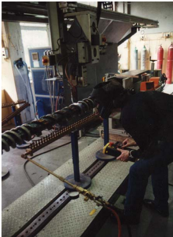
Abb. 2: Prozessbeobachtung und Optimierung beim Auftragschweißen mit Robotern
