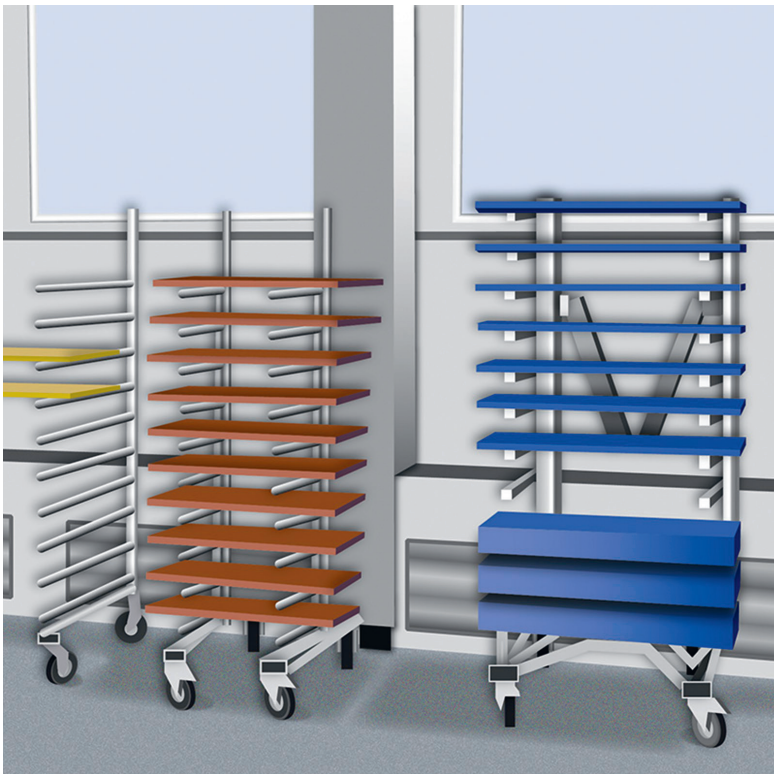
Abbildung oben: Unzulässige Anordnung von zu trocknenden Werkstücken beim Spritzlackieren
