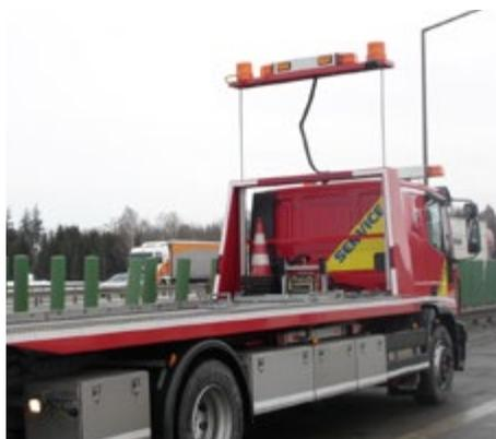
**Abb. 7** Teleskopierbare, weit sichtbare Warnleuchten
