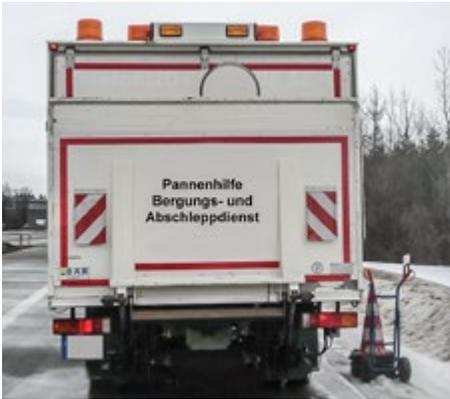
Abb. 8 Warnleuchten in Doppelblitztechnik
