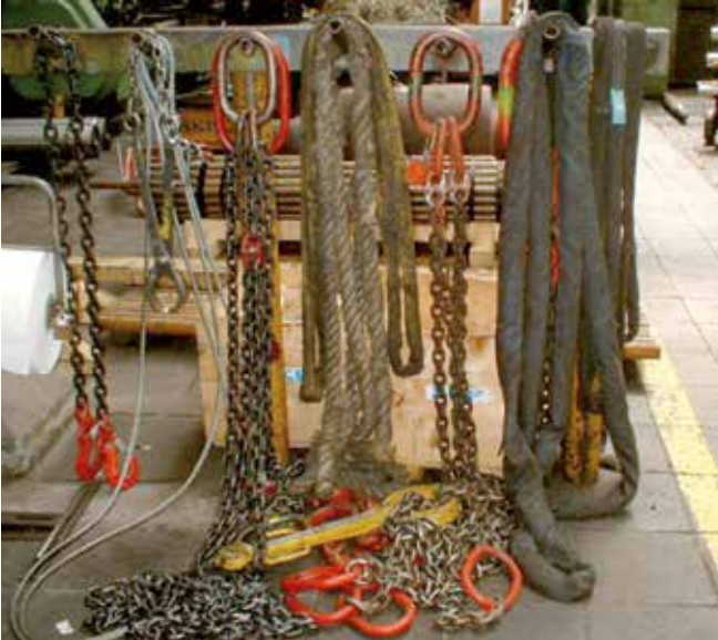
Bild 5-1: Ungünstige Lagerung von Anschlagmitteln, Beispiel 1
