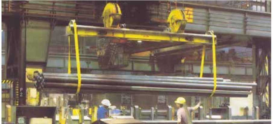
Bild 1-11: Sicheres Anschlagen langer Lasten
