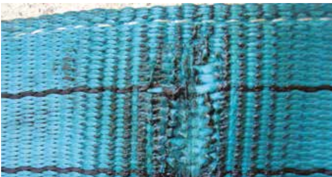
Bild 4-3: Durch Wärmeeinfluss beschädigte Oberfläche
