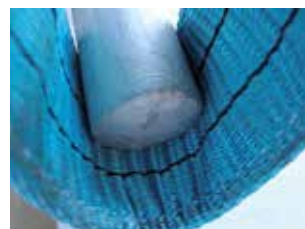
Bild 1-8: Unzulässige Auflage der Last im Hebeband
