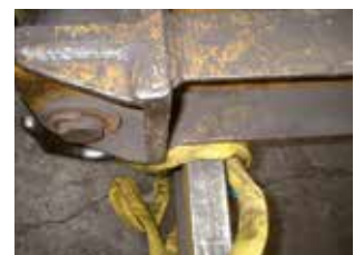
Bild 1-9: Beschädigung einer Rundschlinge durch darauf abgesetzte Traverse
