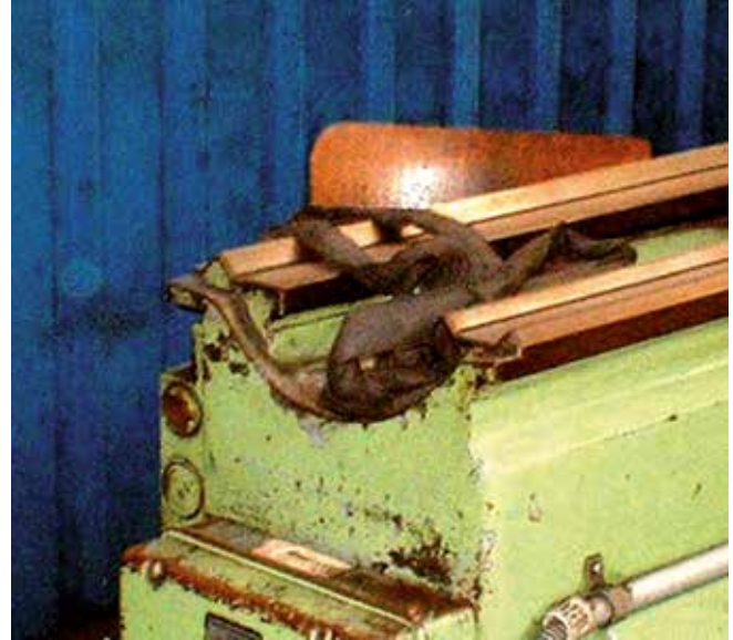
Bild 5-2: Ungünstige Lagerung von Anschlagmitteln, Beispiel 2
