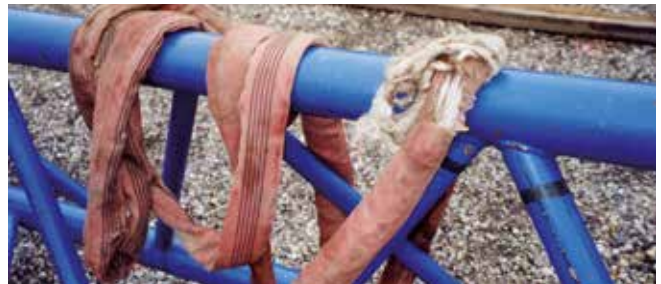
Bild 4-5: Starke Beschädigung der Ummantelung und der Einlage
