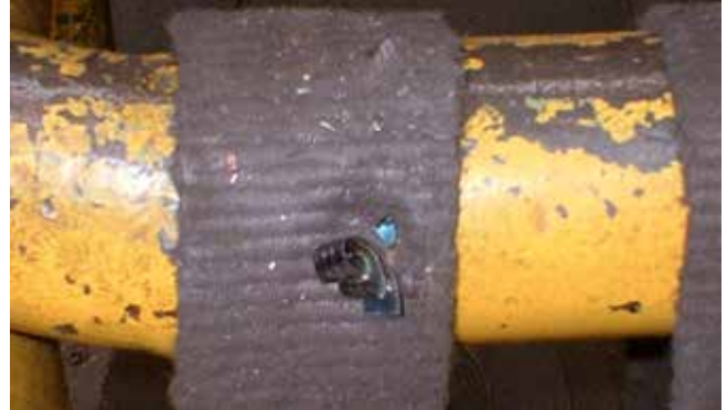
Bild 4-4: Durch heißen Span beschädigte Oberfläche
