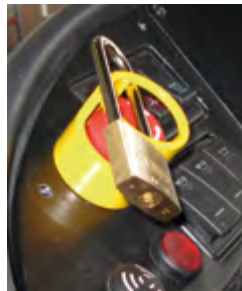
Bild2: Beispiele für das Sichern gegen Wiedereinschalten
