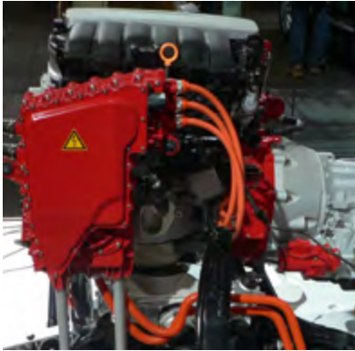
Bild 5: Basisschutz durch Isolation und Abdeckung
