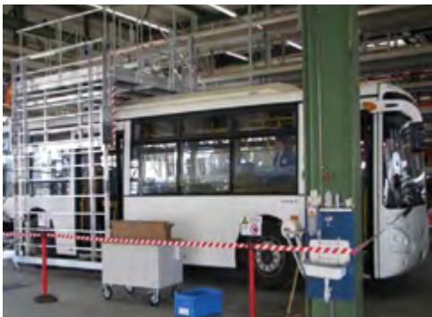
Bild 8: Beispiel für Absichern des Arbeitsbereichs bei Prüfarbeiten
