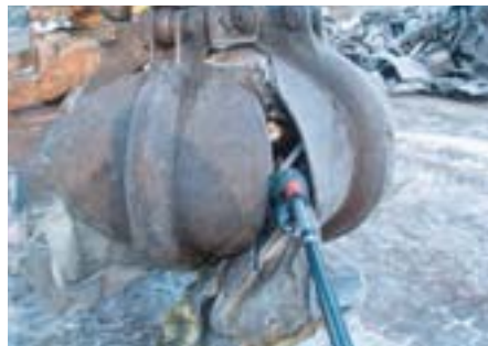
Bild 3-1: Vereinzelung von Schrott mittels Detektor-Handmessgerät, Beispiel 1
