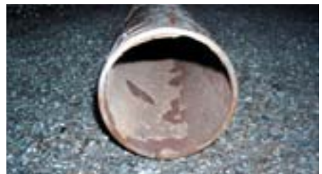
2-3: Rohr mit radioaktiven Anhaftungen (innen)
