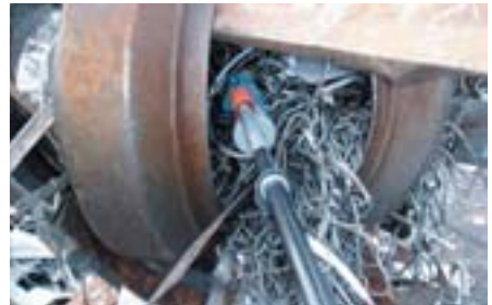
2-3: Rohr mit radioaktiven Anhaftungen (innen)
