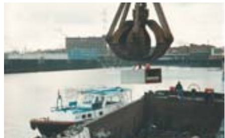
Bild 2-7: Einzelner Detektor am Kran hängend zur Überwachung von Schiffsloadungen
