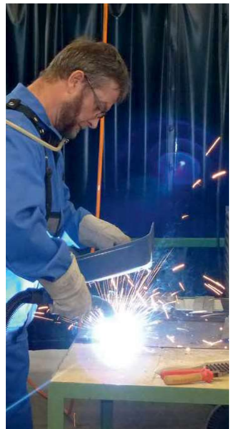
Personengetragene Schweißrauchmessung beim MAG-Schweißen ohne (oben) und mit Brennerabsaugung (unten).
