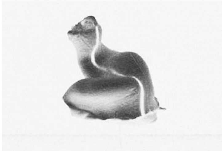
Abbildung 3: Lichtschnitt (helle Linie) auf einer Ohrabformung
