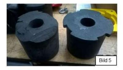
Die Bruchstellen sind deutlich erkennbar. Im Hintergrund ist der Befestigungsring ersichtlich (gelb), mit dem die Puffer am Kran befestigt werden.
