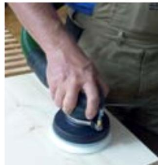
Abb. 1: Bearbeitung von Holzoberflächen mit einem Druckluftexzentrerschleifer (Einhandgerät)
