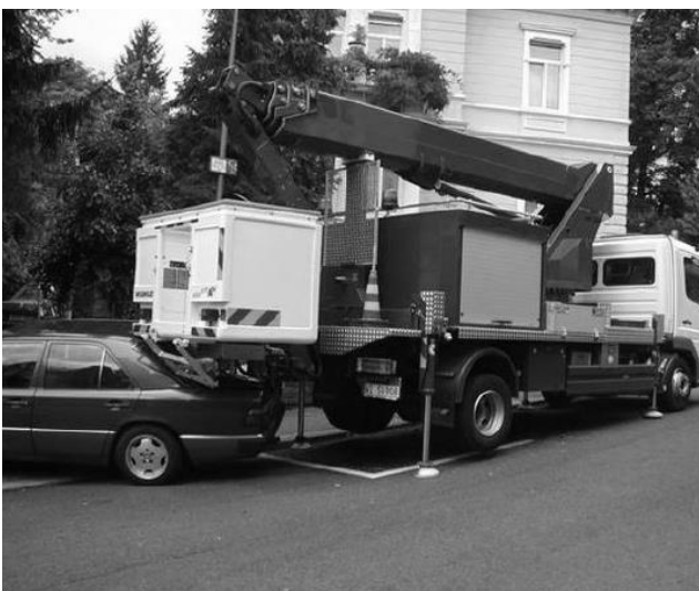
Bild 1: Unfall beim Abstützvorgang am Hang
