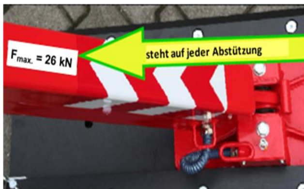
Bild 5: Abstützung mit angegebenem max. Stützdruck
