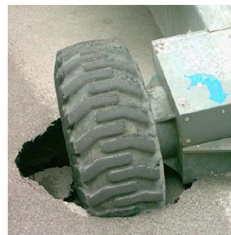
Bild 3: Eingebrochenes Rad einer FHAB
