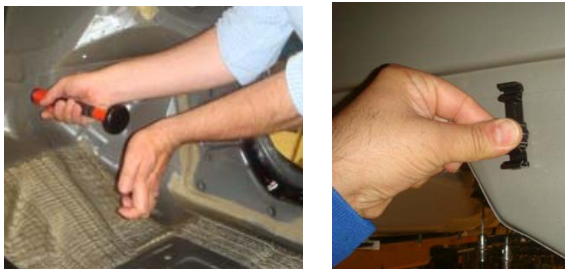
Bilder 2/3: Beispiele für Manuelles Einklopfen/Einpresse von Teilen (Quelle: BGHM)
