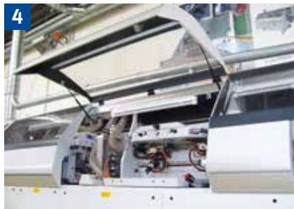
Werden die Gefahrstellen der Werkzeugaggregate z. B. mit elektrisch verriegelten Schutzhauben (gegebenfalls mit Zuhaltung) gesichert?
