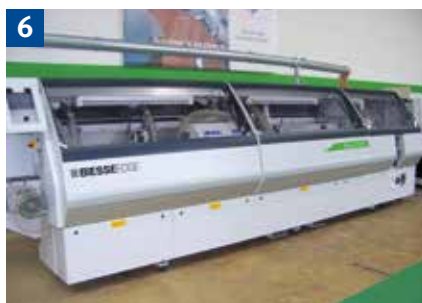
Werden die Werkzeugaggregate mit elektrisch verriegelten Schutzhauben – gegebenenfalls ergänzt mit einer Zuhaltfunktion – gegen Erreichen gesichert?
