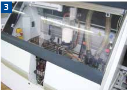
Sind die Gefahrstellen der Stachelwalze gesichert, z.B. mit einer elektrisch verriegelten Schutzhaube oder durch eine fest verschraubte Verkleidung?
