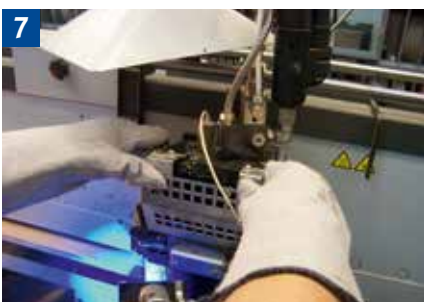
Bei Arbeiten an Leimbehältern Schutzhandschuhe tragen.
