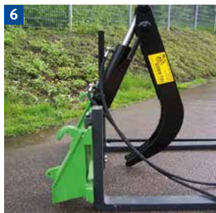
Gabelstapler mit Zangengreifer zum Transport von Rundholz
