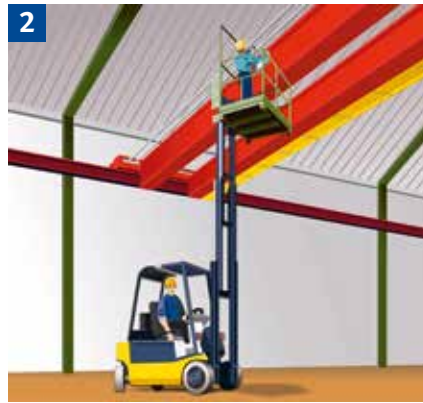
Instandhaltungsarbeiten mit Gabelstapler und Arbeitsbühne
