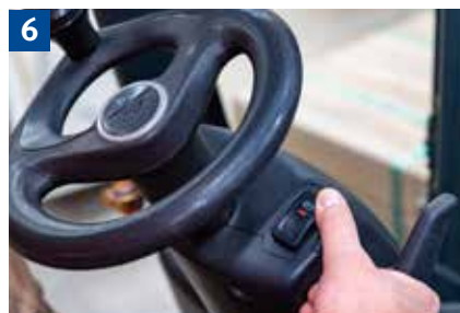
6 Vor Verlassen des Flurförderzeugs Feststellbremse anziehen und Gabeln absenken. Auf geneigten Flächen zusätzlich durch Unterlegkeile das Wegrollen verhindern.
