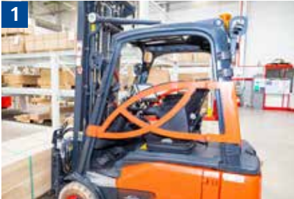
1 Fahrerrückhalteeinrichtung (hier: Bügeltür) bei jeder Fahrt benutzen.
