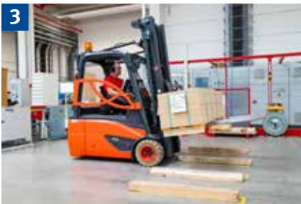
3 Last am Gabelrücken anlegen, Hubmast nach hinten neigen. Gabelzinken gleichmäßig belasten, in niedriger Stellung verfahren.
