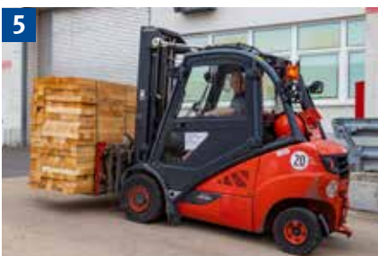
5 Im Gefälle und in Steigungen Last immer bergseitig führen und nicht wenden.
