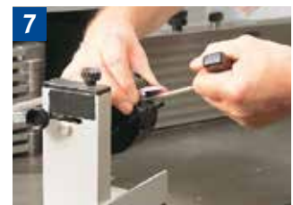
Lösen der Spannschrauben mit vorgegebenem Werkzeug (Imbusschlüssel)
