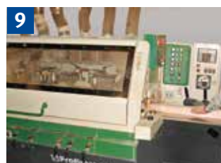
Mechanischer Vorschub = z. B. Arbeiten mit Mehrseiten-Hobel- und Fräsmaschine
