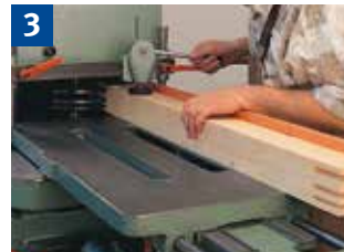
Handvorschub = Arbeiten mit dem Schiebeshlitten
