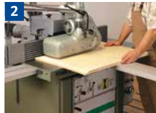
Handvorschub = Arbeiten mit dem Vorschubapparat
