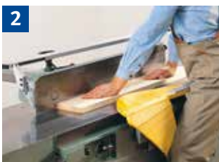
2 Abrichten breiter Werkstücke mit Gliederschwingschutz
