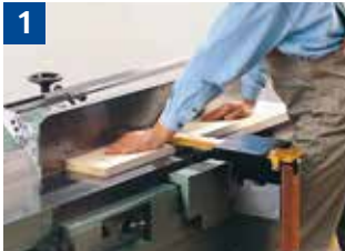
1 Abrichten breiter Werkstücke mit Schutzbrücke
