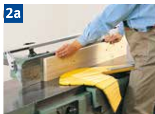
2a Fügen breiter Werkstücke mit Gliederschwingschutz
