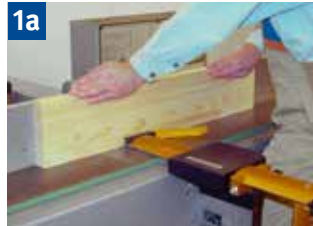
1a Fügen breiter Werkstücke mit Schutzbrücke
