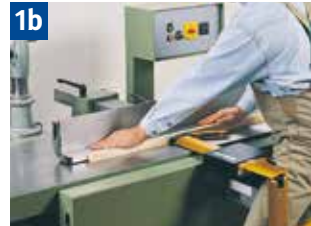
1b Abrichten und Fügen schmaler Werkstücke mit Schutzbrücke und Hilfsanschlag
