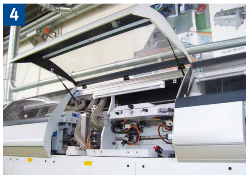
4 Werden die Gefahrstellen der Werkzeugaggregate z. B. mit elektrisch verriegelten Schutzhauben (gegebenfalls mit Zuhaltung) gesichert?
