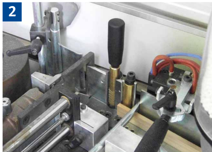
2 Gefahrstellen der Stachelwalze
