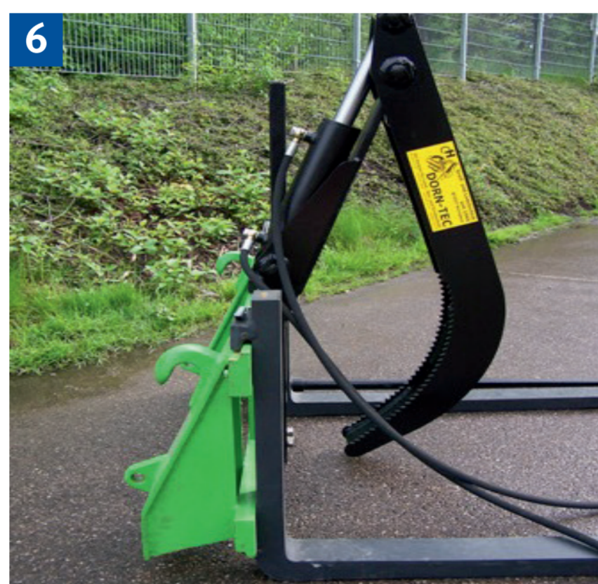
Gabelstapler mit Zangengreifer zum Transport von Rundholz
