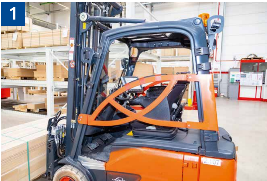
1 Fahrerrückhalteeinrichtung (hier: Bügeltür) bei jeder Fahrt benutzen.
