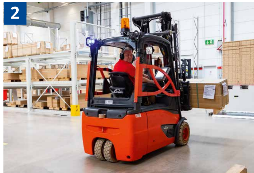
2 Niemals ohne Sicht fahren. Beim Transport hoher Lasten ausnahmsweise rückwärts fahren oder sich einweisen lassen.
